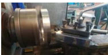
شکل ۱۸: لحظه نزدیک شدن رنده تراشکاری به سطح قطعه کار
