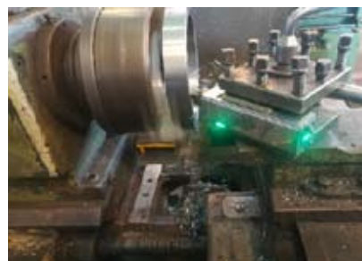
شکل ۲۱: مماس شدن نوک رنده تراشکاری به سطح قطعه کار و فعال شدن هشدار دهنده‌های نوری و صوتی بصورت ممتد
