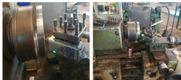
شکل ۱۹: لحظه نزدیک شدن نوک رنده تراشکاری به سطح قطعه کار فعال شدن هشدار دهنده‌های نوری و صوتی به صورت غیر ممتد
