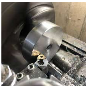
شکل ۱۳: مماس شدن رنده تراشکاری به سطح قطعه کار
