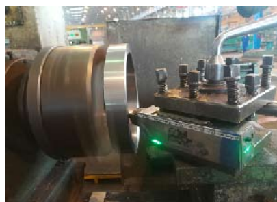
شکل ۲۰: مماس شدن نوک رنده تراشکاری به سطح قطعه کار و فعال شدن هشدار دهنده‌های نوری و صوتی بصورت ممتد
