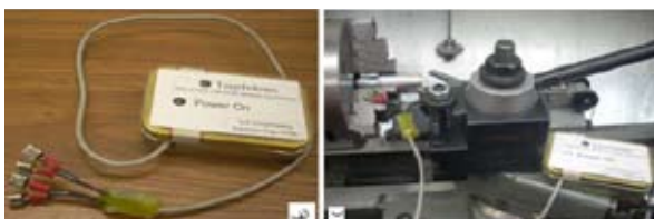
شکل ۱۷: الف) تاستر ماشین ابزار تراش، ب) تاستر نصب شده
